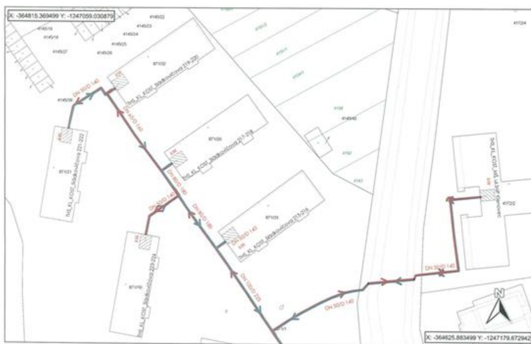
Obrázok 16 Dispozičné usporiadanie rozvodov tepla SCZT Sládkovičova ulica
